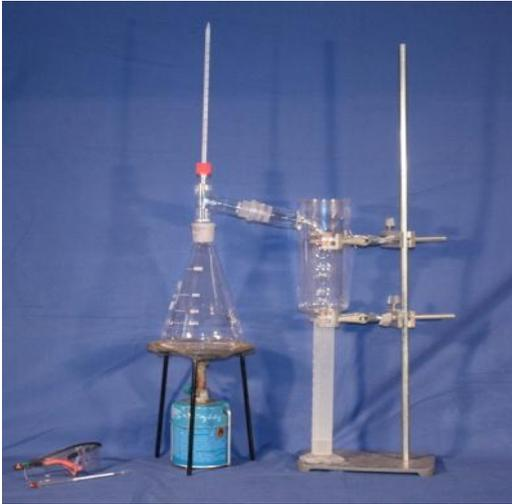
**Material:** Bunsenbrenner, Erlenmeyerkolben (1L), Becherglas, Messzylinder (100 mL), Dreifuß, Kühler, Thermometer, Spindel, Alkoholmeter, Standfuß mit Stativstange, Schutzbrille
