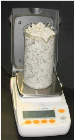
2. Geben Sie 1000 ml Citrat-Hydrolysepuffer (pH = 5) zum zerkleinerten Altpapier.
