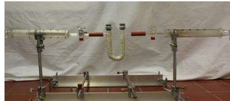
*Image : équipement pour assainir le biogaz. Le tuyau en U est rempli avec de la chaux sodée.*
