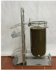
1.1 Remplir 90 pour cent du fermenteur avec l'inoculum et faire attention a ce que ce soit étanche au gaz lorsque c'est ferme. L'inoculum est compose de pertes de fruits avec des micro-organismes vivants.
